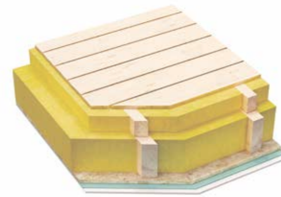
Aufbau der Kehlbalkendecke zum unbeheizten Spitzboden
